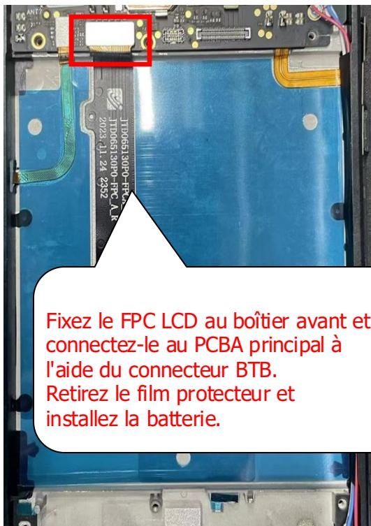
Fixez le FPC LCD au boîtier avant et connectez-le au PCBA principal à l'aide du connecteur BTB.
