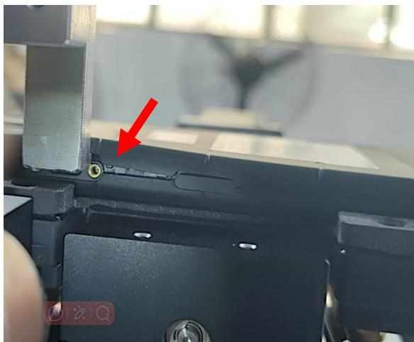
5. Retirez le couvercle de la batterie à l'aide d'un outil d'ouverture (par exemple, un outil iFixit ou un « bâton noir »).
