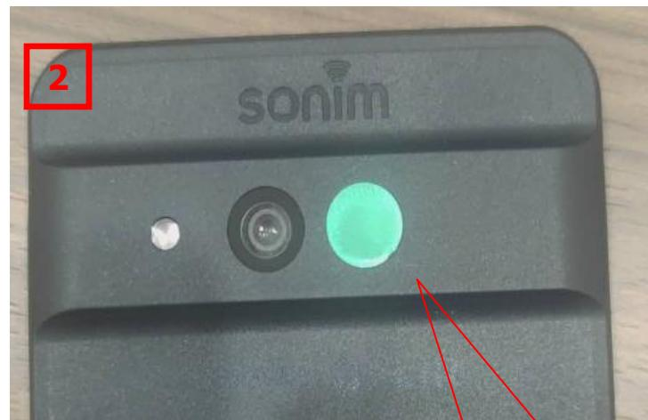
Le côté vert de l'objectif de la caméra infrarouge se trouve à l'extérieur.
