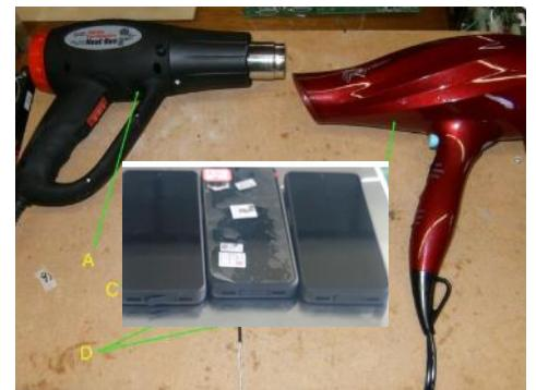
4. Après avoir chauffé le couvercle de la batterie, séparez-le du boîtier avant.
